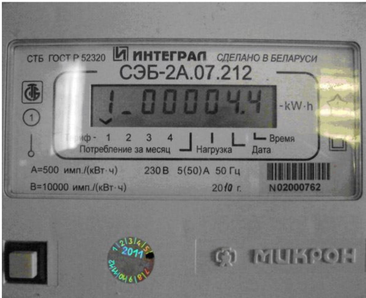
Индикация количества электроэнергии учтенной по тарифу 1 (при использовании одноставочного тарифа значение параметра тарифа 1 соответствует значению суммы. При программировании электросчетчика на оплату по дифференцированному тарифу по зонам суток значение Т1 - соответствует дневному тарифу, Т2 – соответствует ночному тарифу).
