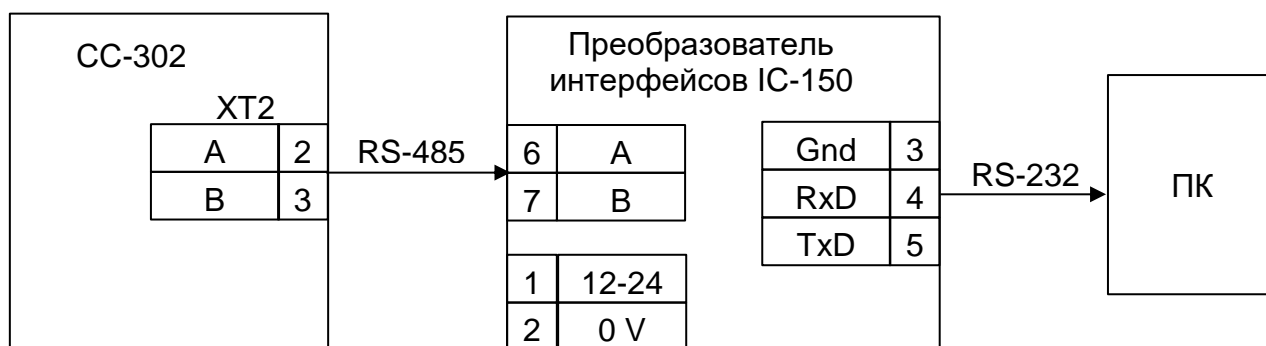
Рисунок Д.3 – Схема подключения счетчиков к компьютеру по интерфейсу RS-485
