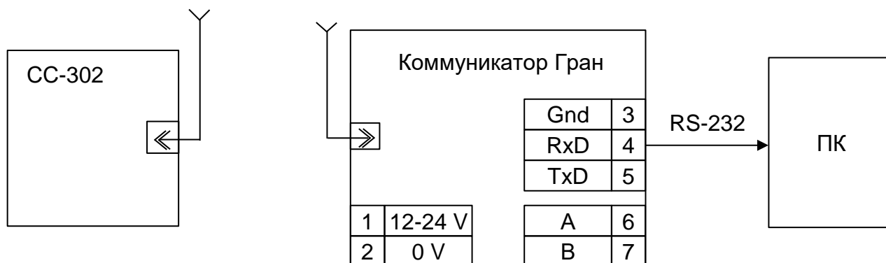
Рисунок Д.8 – Схема подключения счетчиков к компьютеру по 3G
