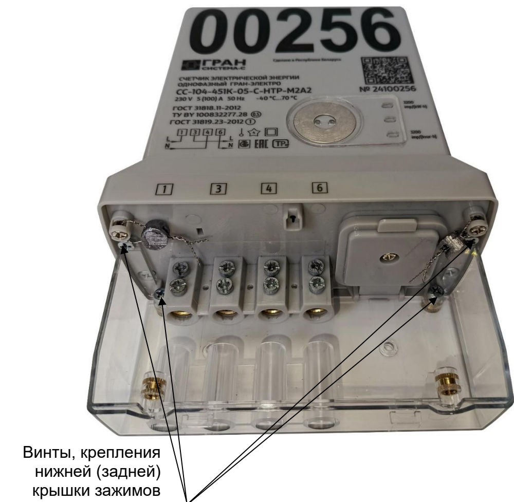
Рисунок Д.2 – Расположение винтов крышки зажимов
