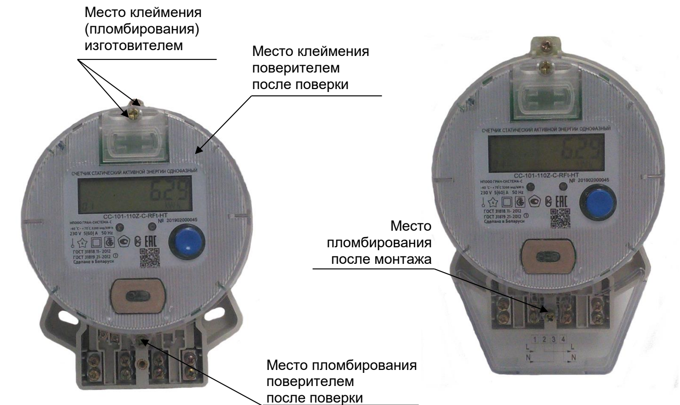
Рисунок В.1 – Места клеймения и пломбирования счетчиков «Гран-Электро СС-101-11Х 1 Е2», «Гран-Электро СС-101-11Х 1 З»
