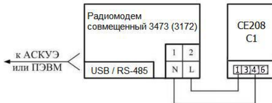
Рисунок 7. Схема подключения счетчика через PLC-интерфейс
