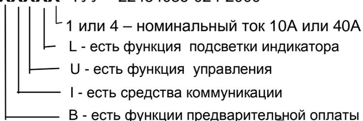
Примечание - В обозначениях счетчиков буквы после точки присутствуют только при наличии соответствующих функций
